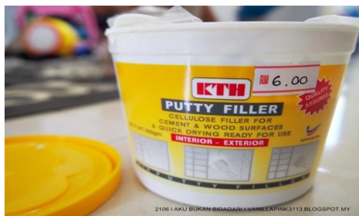
Gambar 2. Contoh Putty Filler (Gam Simen) 5% campuran yang digunakan oleh pengkaji sebagai material utama simenfero.
