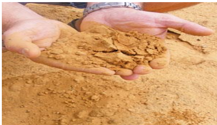
Gambar 1. Contoh Red Clay 20% campuran yang digunakan oleh pengkaji sebagai material utama simenfero.
